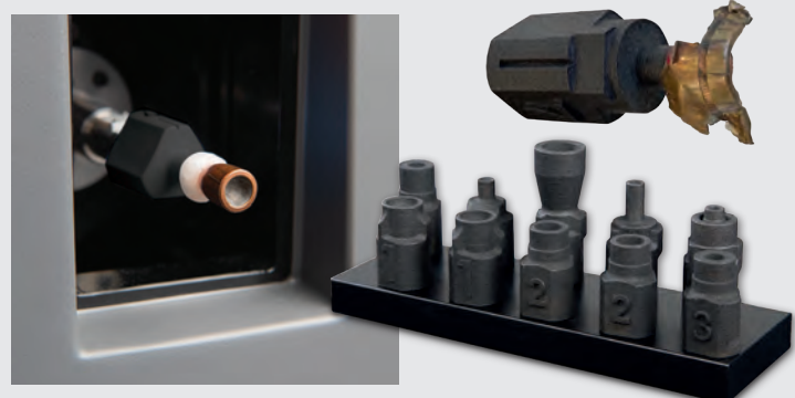
El portamuestras se fija magnéticamente al eje y se retrae automáticamente
