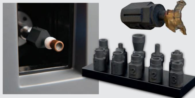
· L'embout est fixé magnétiquement à l'arbre et se rétracte automatiquement
